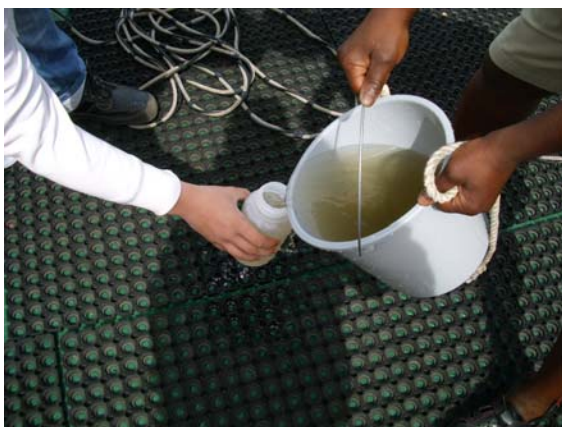
Wasser-Probenentnahme an Bord der „Wedel“, um u.a. den Salzgehalt der Elbe zu prüfen
