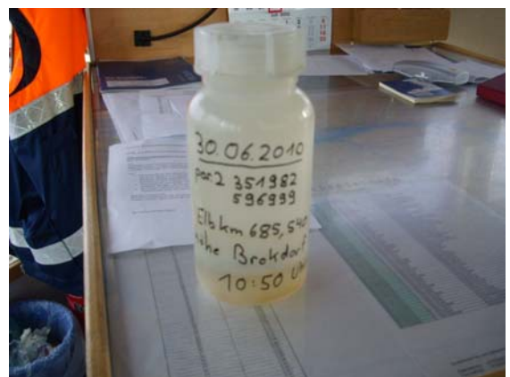
Wasser-Probenentnahme an Bord der „Wedel“, um u.a. den Salzgehalt der Elbe zu prüfen
