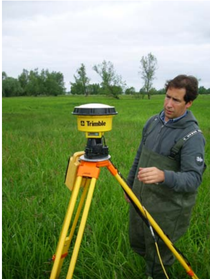
Vermessung auf Pagensand mithilfe von GPS-Signalen
