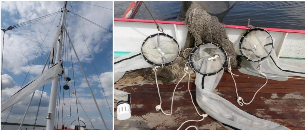
Abb. 4: Ringnetzensemble zur Erfassung der Fintenlaichprodukte in der Tideelbe. Konfiguration mit 3 Netzen.
