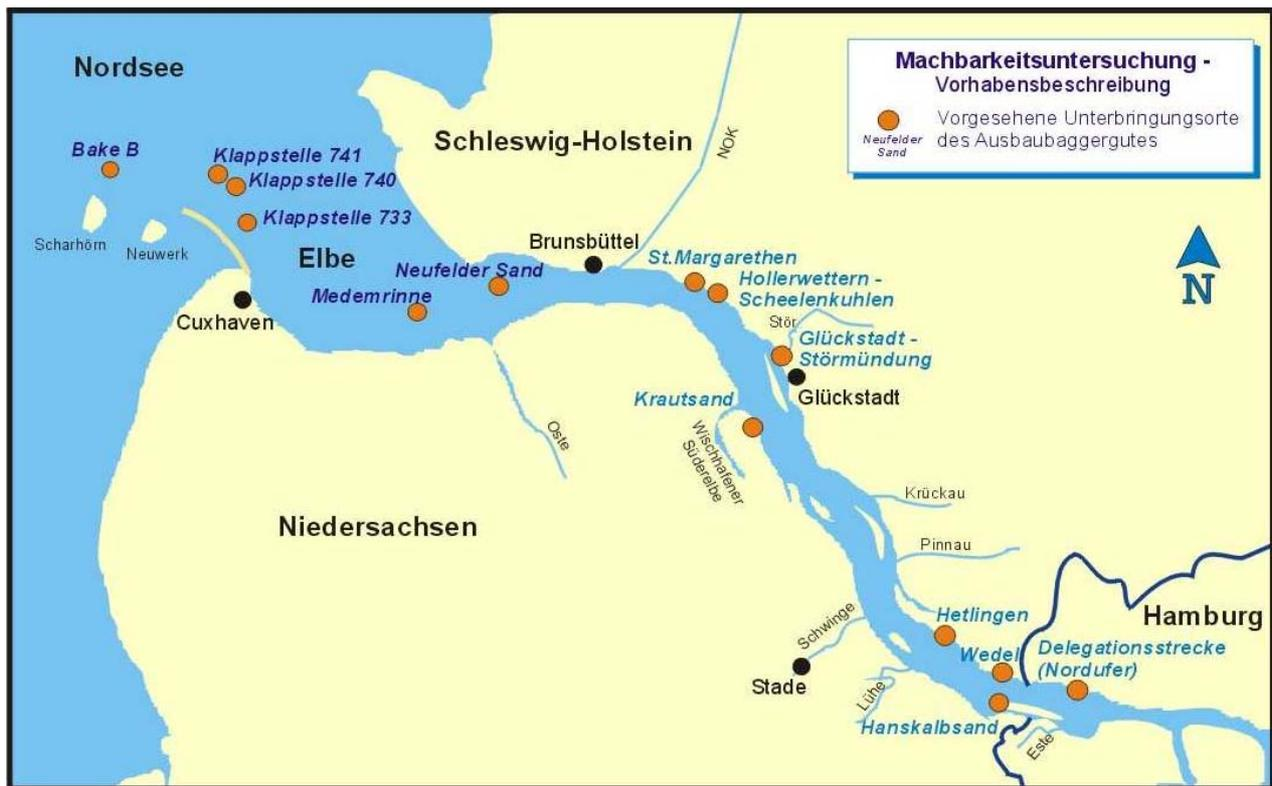
**Abb. 1.2-3: Unterbringungsorte des Ausbaubaggergutes (verändert nach PG Voruntersuchung 2003)**
