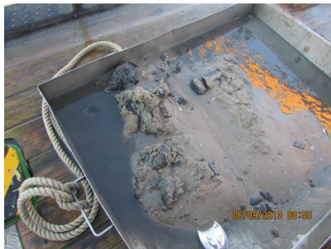
Abbildung 8-15: Probe 506-109, aus der die Schlickbrocken entnommen und als separate Probe 506-110 analysiert worden ist, Probennahme September 2013
