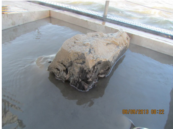
Abbildung 8-18: Proben 506-104 (Teilprobe sandige Auflage) und Probe 506-105 (Teilprobe dunkles, schluffiges Sediment unter der sandigen Auflage), Datum der Probennahme September 2013
