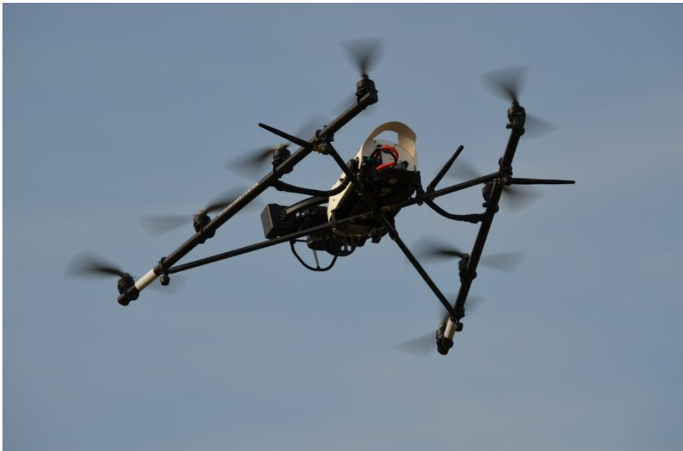
**Abbildung 2-3: UAS - Drohne mit Spiegelreflexkamera (Foto: Hannes Sahl)**
