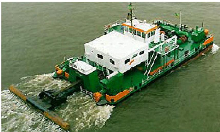
**Abbildung 2.3-3: Wasserinjektionsgerät (Foto: WSA Hamburg)**
