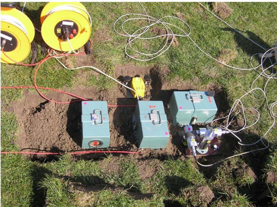
**Bild 3 Messpunkt 4 mit SM3-1D-Sensor, Kebe-3D-Sensor und IB301-Sensor**
