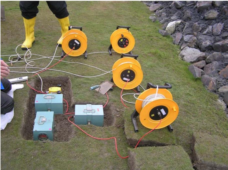
**Bild 2 Messpunkt 1 mit SM3-1D-Sensoren und Kebe-3D-Sensor beim Aufbau**
