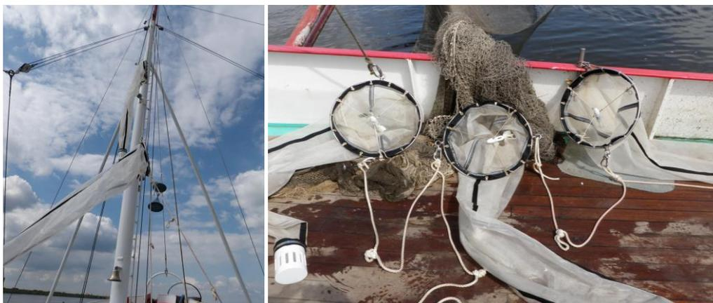
**Abb. 3:** Ringnetzensemble zur Erfassung der Fintenlaichprodukte in der Tideelbe.
