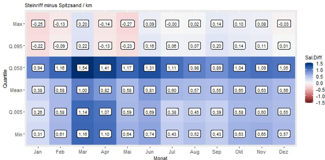
**Abbildung 4-9: Laterale Gradienten der Salinität, quer zur Fahrrinne, zwischen Steinriff (SW) und Spitzsand (NE)**
