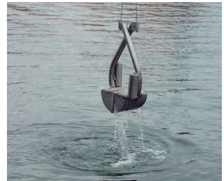
Abb. 3: van Veen Greifer im Einsatz
