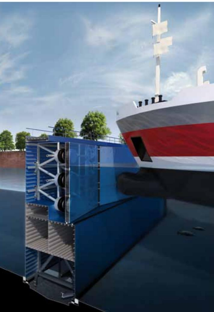
Abb. 3: Geplantes Schleusentor im Schiffsanprall
