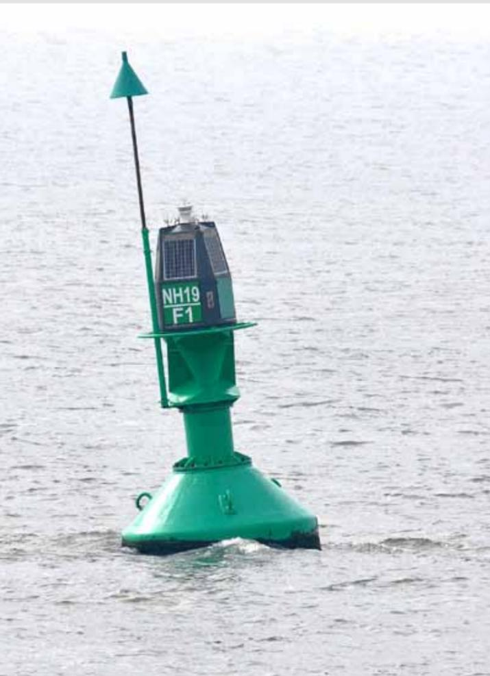
Abb. 1: Leuchttonne mit Solarkompaktaufsatz
