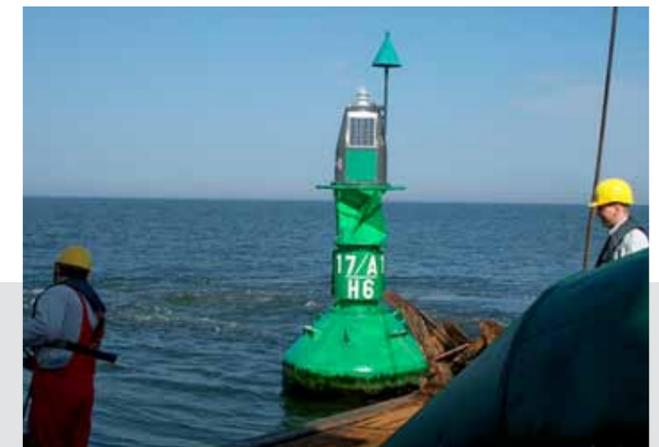
Abb. 3: Leuchttonne mit Solarkompaktaufsatz
