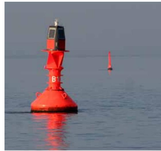
Abb. 2: Leuchttonne mit Solarkompaktaufsatz
