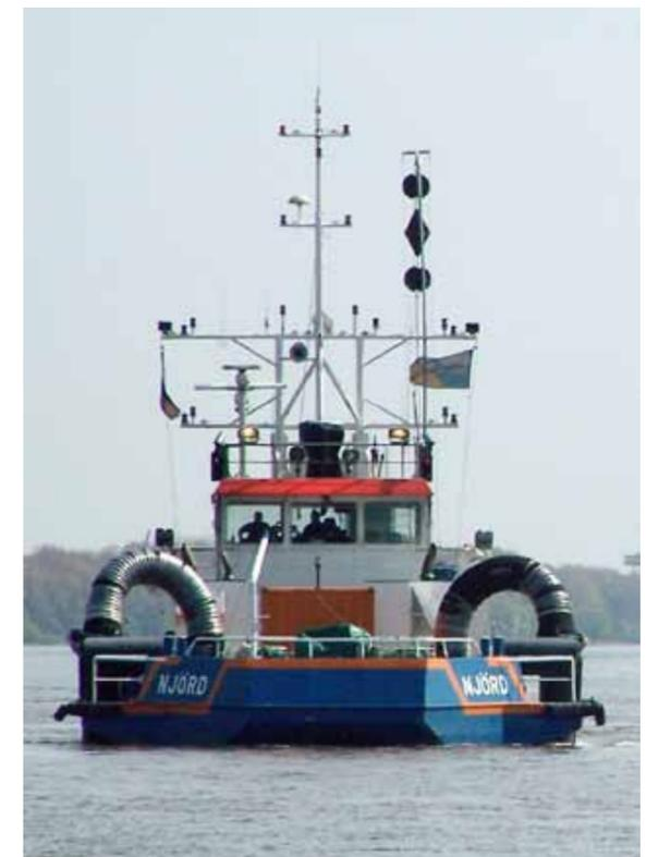
Abb. 2: WI-Bagger „Njörd“
