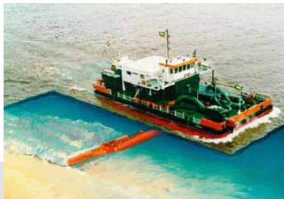
Abb. 1: Wasserinjektionsgerät (Quelle: HAM DREDGING)
