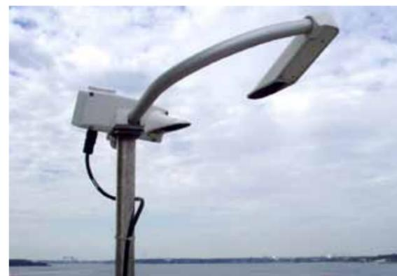
Abb. 1: Sichtweitenmessgerät - Leuchtturm Kiel-Friedrichsort
