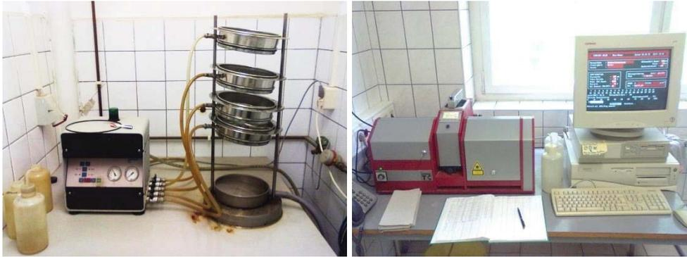
**Abbildung 14 links: Stapelsiebanlage, rechts: Laserbeugungsspektrometer**
