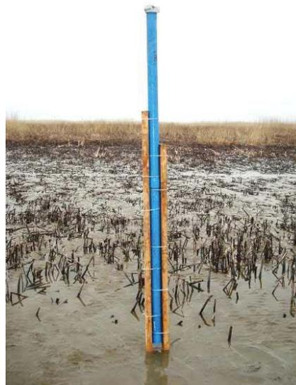
**Abbildung 13 Messung des Wasserstandes, links: Ecolog500 (Bildquelle: OTT), rechts: Montage der Brunnenfilter**
