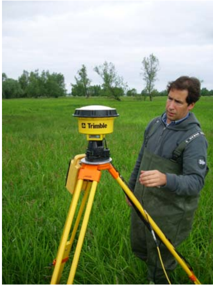
Vermessung auf Pagensand mithilfe von GPS-Signalen
