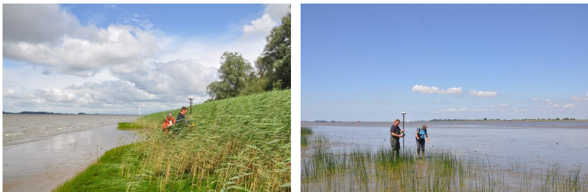
Abb. 3: Transektkartierung gemeinsam mit dem WSA-Vermesser mittels DGPS-Empfänger im Röhricht sowie im Bereich der unteren Vegetationsgrenze im Sommer 2015
