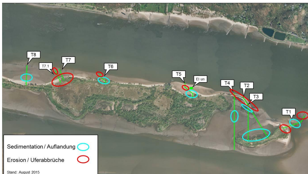
Abb. 4: Schematische Darstellung der Entwicklung der Transekte T1 bis T8 hinsichtlich Erosion und Sedimentation im Monitoringzeitraum 2009-2015 - Details vgl. Tab. 2 sowie Profilzeichnungen - Hinweis: Die Transekte T7 und T8 konnten im Sommer 2015 aufgrund hoher Wasserstände nicht bis zur MTnw-Linie vermessen werden.
