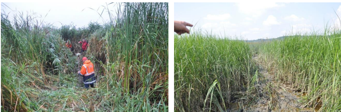
Abb. 3: Transektvermessung mit DGPS-Empfänger: Herstellen einer Schneise zur Begehung der Vegetationsbestände und zur Sicherstellung des Empfangs im bis zu 4 m hohen Schilf (links) bzw. im Strandsimsen-Bestand (rechts) am Beispiel der Transekte T2 und T4.
