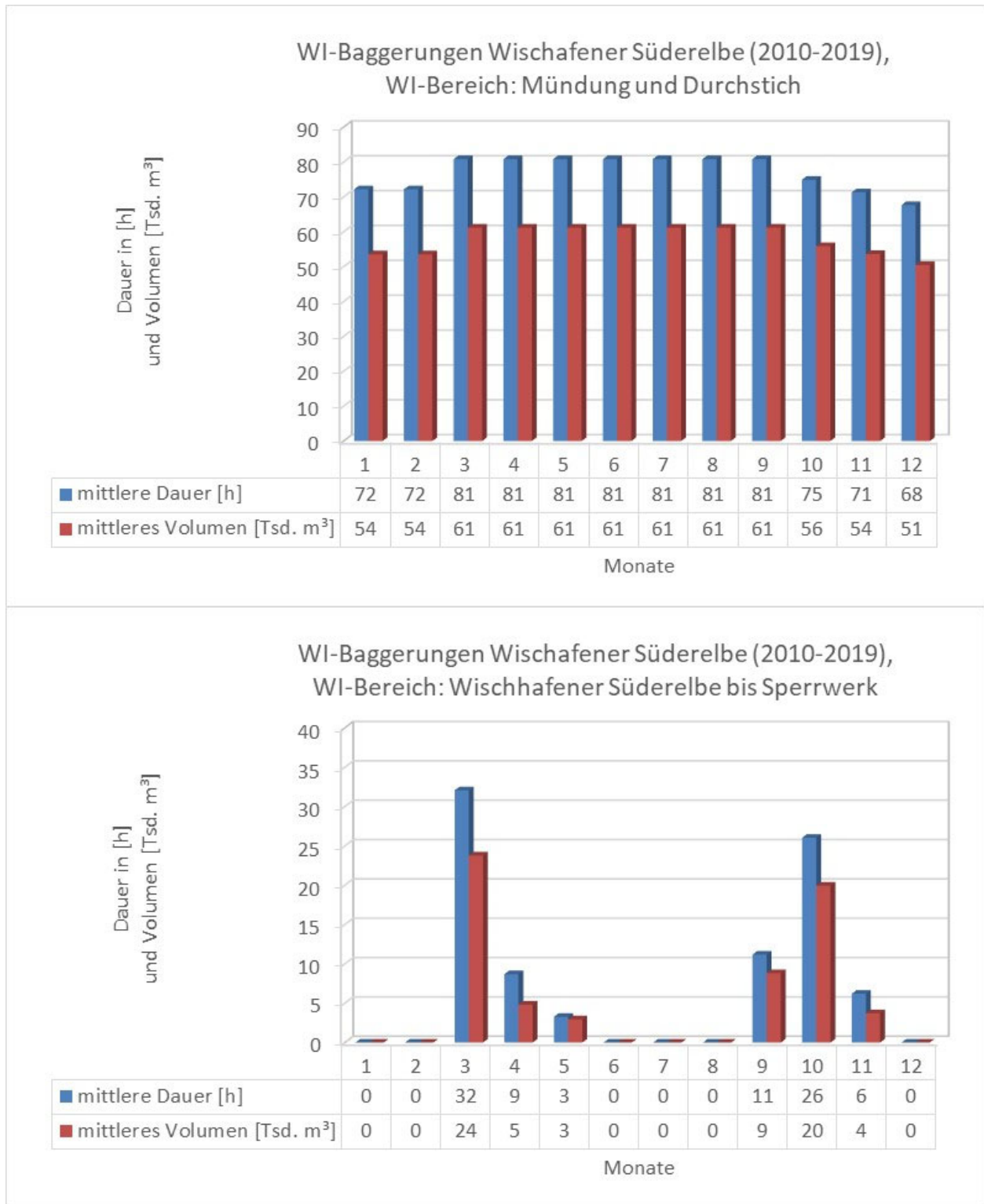
Abbildung 3-17: Verteilung der WI-Baggerungen in der Wischafener Süderelbe inkl. Mündung und Durchstich von 2010 bis 2019 in Dauer und Volumen über die Monate Januar bis Dezember
