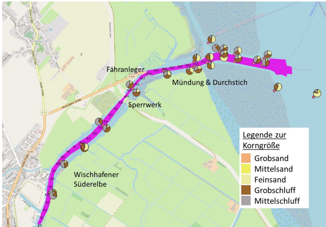
Abbildung 5-12: Korngrößenverteilung an den Probenentnahmestellen in der Wischhafener Süderelbe. (BfG-2028, 2020b)
