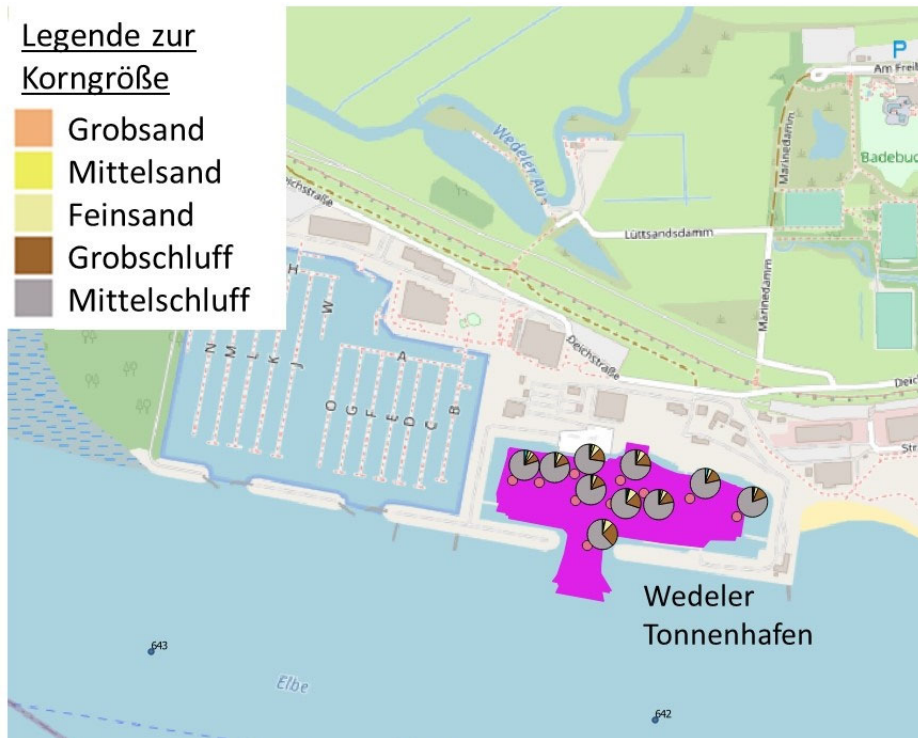
Abbildung 5-22: Korngrößenverteilung an den Probenentnahmestellen im Tonnenhafen Wedel
