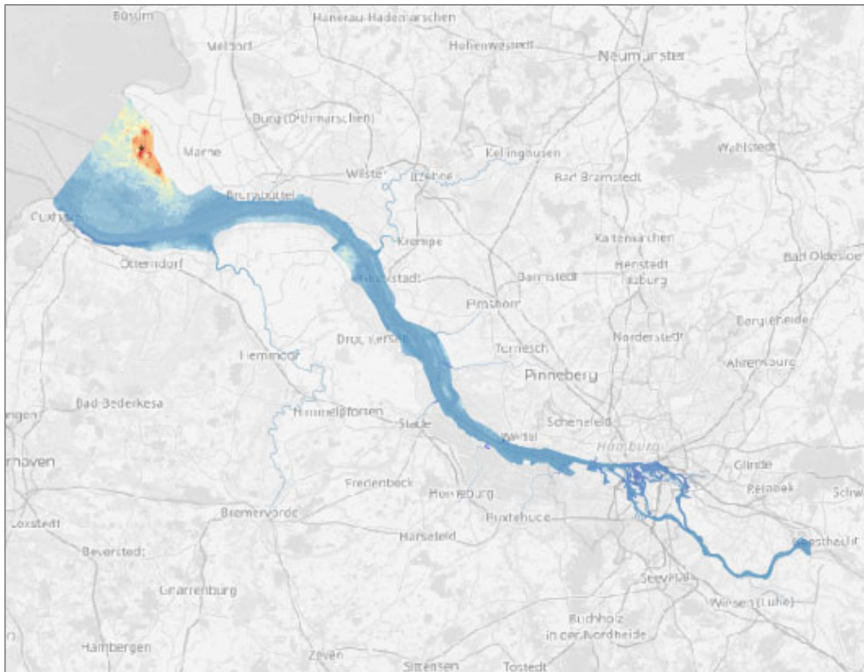
Abbildung 4-2: Abdeckung des verwendeten UnTRIM 2 Ergebnisdatensatzes mit Darstellung der Polygongröße von klein (blau) zu größeren Polygonen im nördlichen Ästuar (über gelb zu rot)
