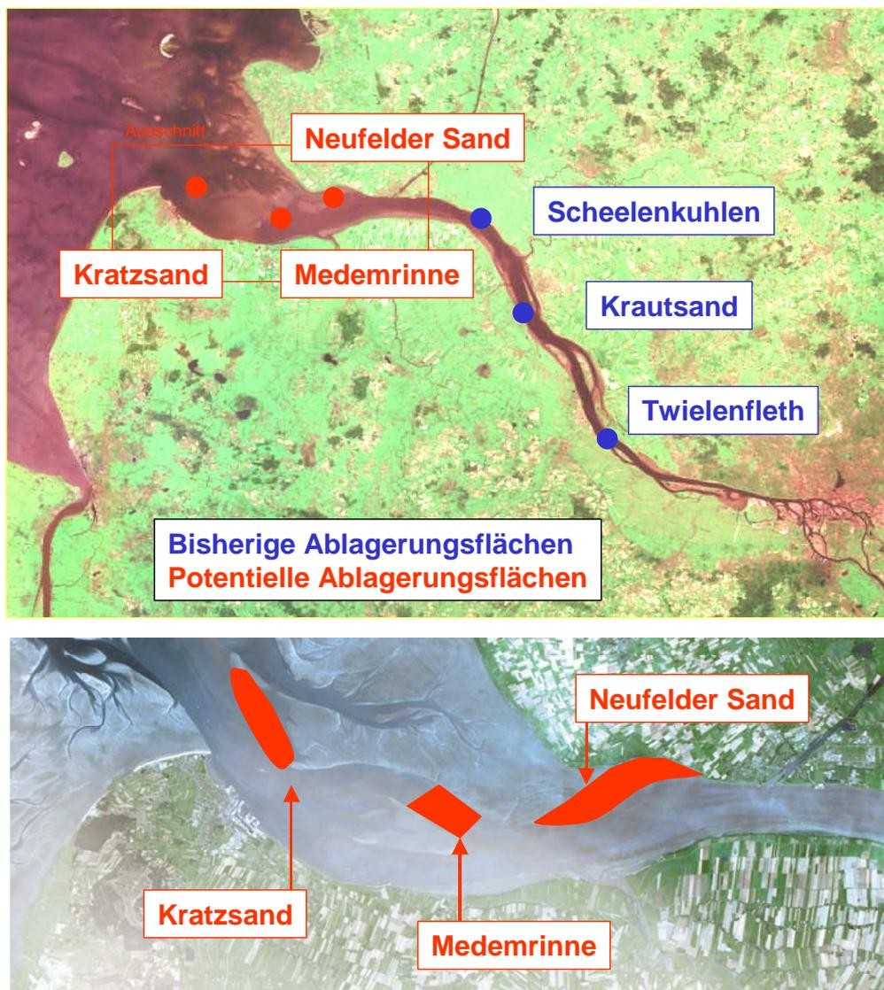
Abbildung 2-1: Übersicht bestehender (in **blau**) und geplanter Unterwasserablagerungsflächen (in **rot**) mit schematischer Lage im Detailausschnitt
