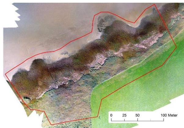
Abbildung 133: Digitales Orthophoto aus Schrägaufnahmen des UAS-Bildflugs mit Phantom 4 RGB-Kamera vom 12.9.2017, GSD: 2 cm, Witterungsbedingungen sonnig, teilweise bewölkter Himmel
