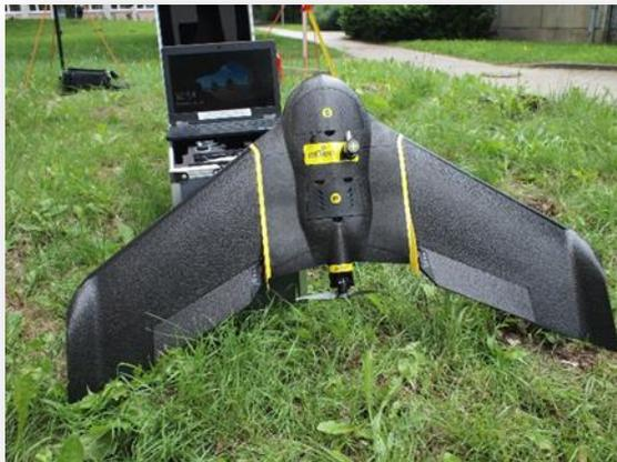
Abbildung 3: Starrflügler UAS Ebee+ mit RTK-GPS und unterschiedlichen Sensoren
