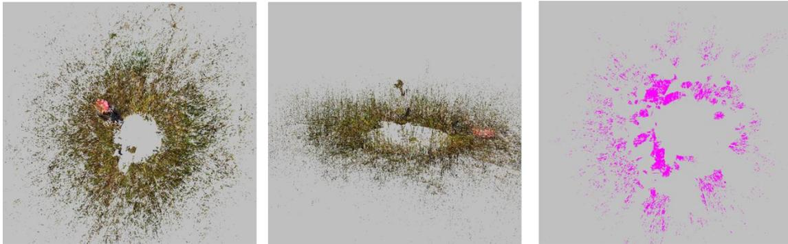
Abbildung 93: TLS-Datenanalyse zur Klassifikation von Bodenpunkten (links: 3D-Punktwolke als Draufsicht, Mitte, Perspektivansicht, rechts klassifizierte Bodenpunkte)
