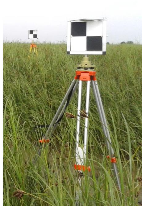
Abbildung 6: Kombinierte Targets für TLS und UAS-Bildflüge auf einem Vermessungsstab oder einem Dreibein montiert
