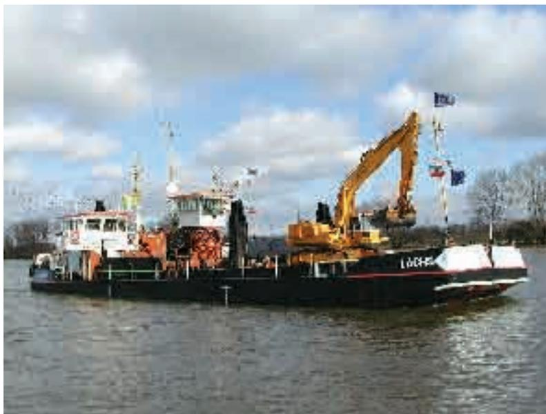
Eine Klappschute wird mit Baggergut beladen.
