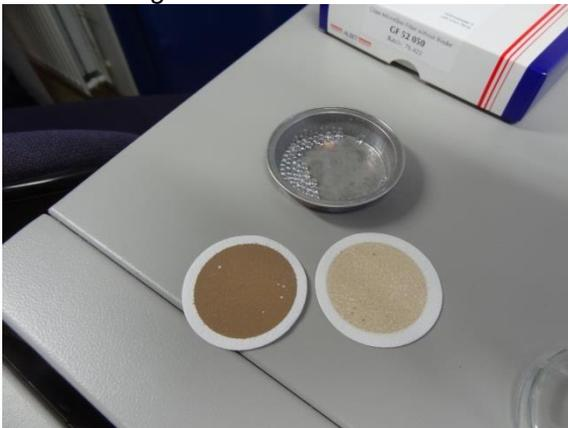
Abbildung 22: GFC-Filter nach dem Trocknen, Aluschale mit Glaskügelchen
