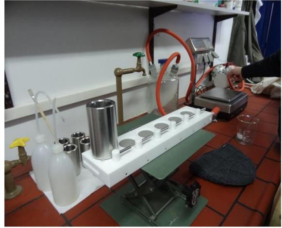
Abbildung 21: Unterdruckfiltrationsanlage
