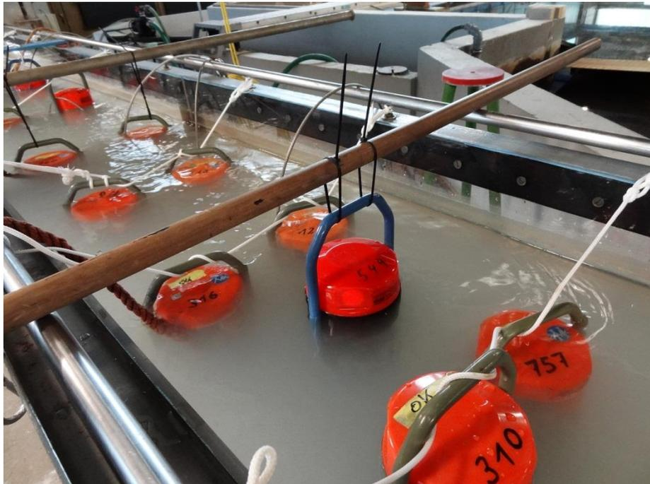
*Abbildung 9: Vergleichsmessung von Trübungssonden*
