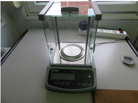
Abbildung 24: Analysewaage
