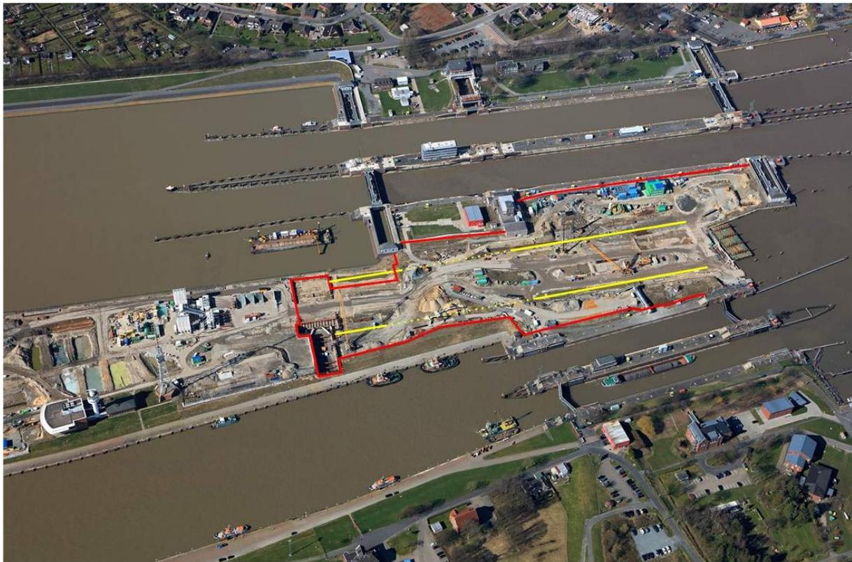
*Die roten Linien zeigen den geänderten Verlauf der Hochwasserschutzlinie. Die durchgezogenen gelben Linien markieren die bereits fertig gestellten Kammerwände und die gestrichelten gelben Linien die noch zu schließenden Lücken in den Kammerwänden.*
