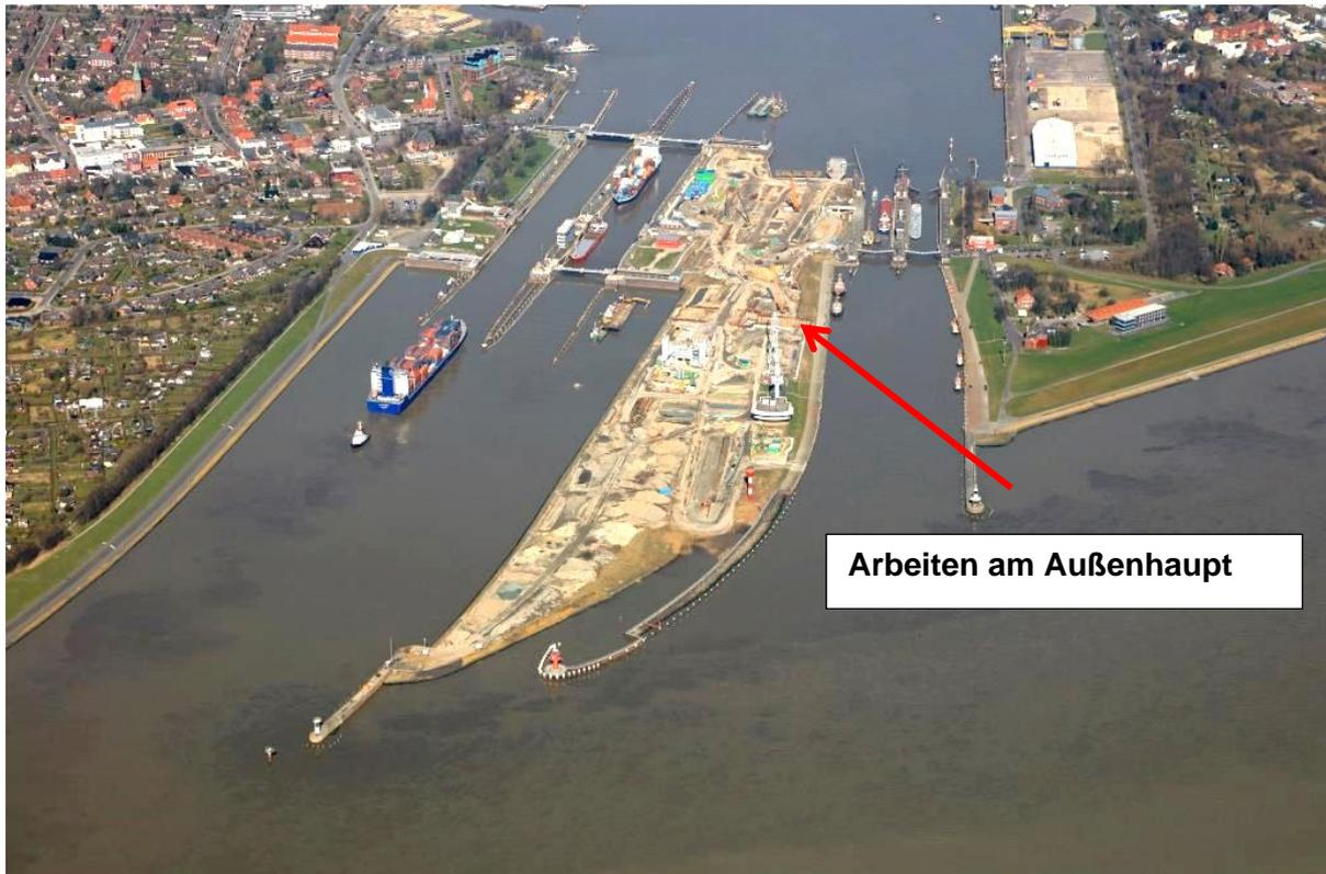
Die geflutete Torkammerbaugrube des späteren Außenhauptes wurde bis -23 m NHN ausgehoben. Der ausgehobene schlammige Boden wurde dabei zuerst mit Flockungsmitteln versetzt und kam dann in Entwässerungsschläuche.
