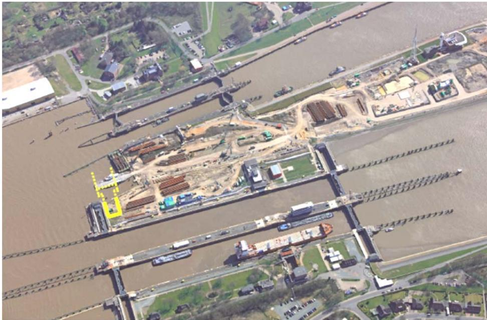
Die gelb gestrichelten Linien markieren die Bereiche des späteren Binnenhauptes, die im Wasser liegen. Die landseitigen Baugrubenwände sind fertig gestellt (durchgezogene gelbe Linie).
