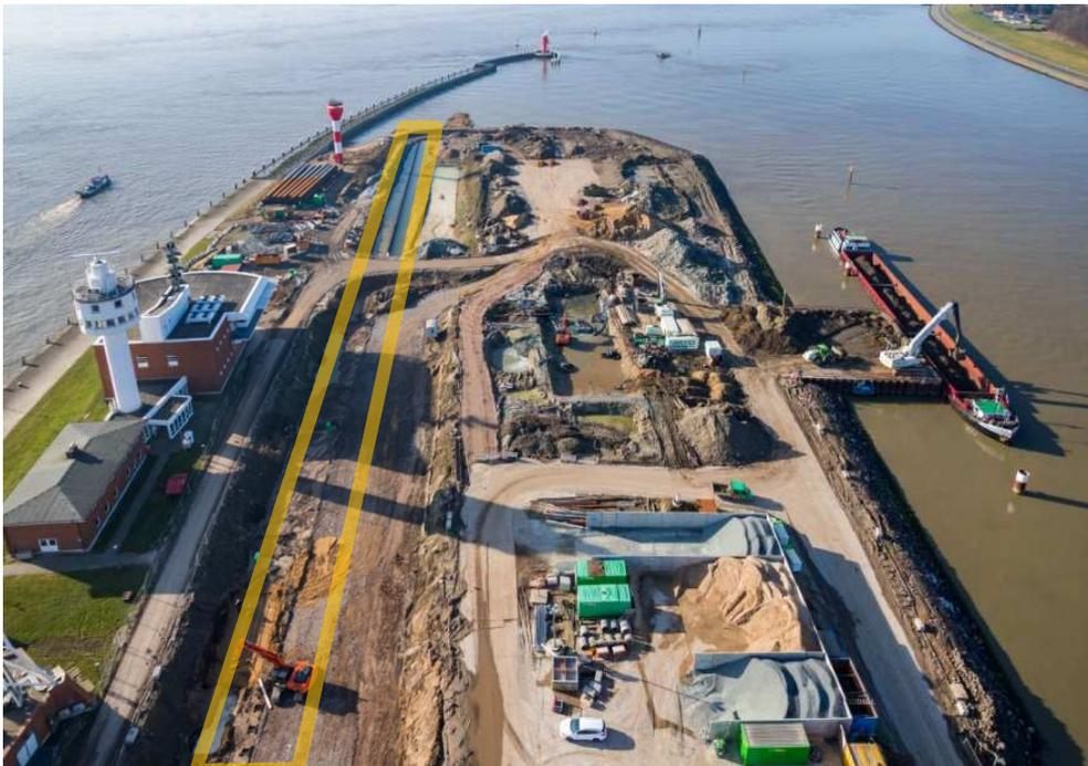
*Die Spundwand zur Sicherung des elbseitigen Vorhafen-Ufers zieht sich als dunkle Linie unterhalb des Gebäudes der Verkehrszentrale Elbe durch den Boden (orange Markierung). Sämtliches Erdreich rechts davon wird später für die Zufahrt zur neuen Schleusenammer weggebaggert.*
