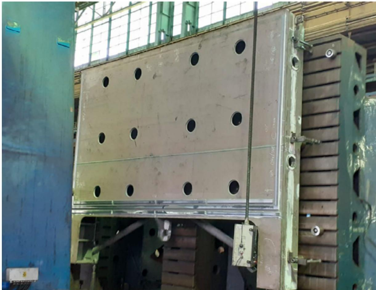
*Fertigung eines der Füll- und Entleerungsschütze, die in die neuen Schleusentore integriert werden und mit denen der Wasserstand innerhalb der Schleusenammer reguliert werden kann. Die Fertigung der Schütze erfolgt im rumänischen Constanta.*
