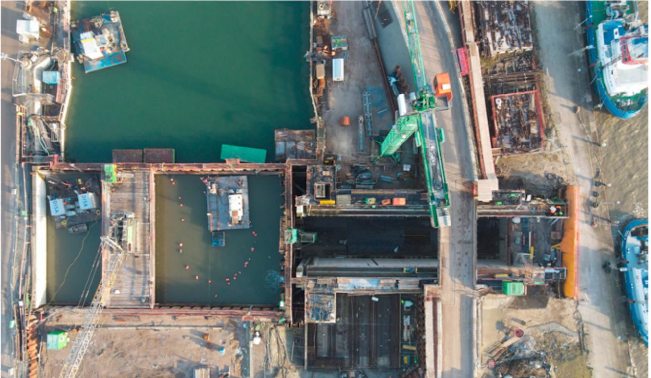
Vogelblick auf das Außenhaupt: rechts die bereits trockengelegte Torkammerbaugrube, links die noch geflutete Drempelbaugrube und darüber die zukünftige Schleusenammer.
