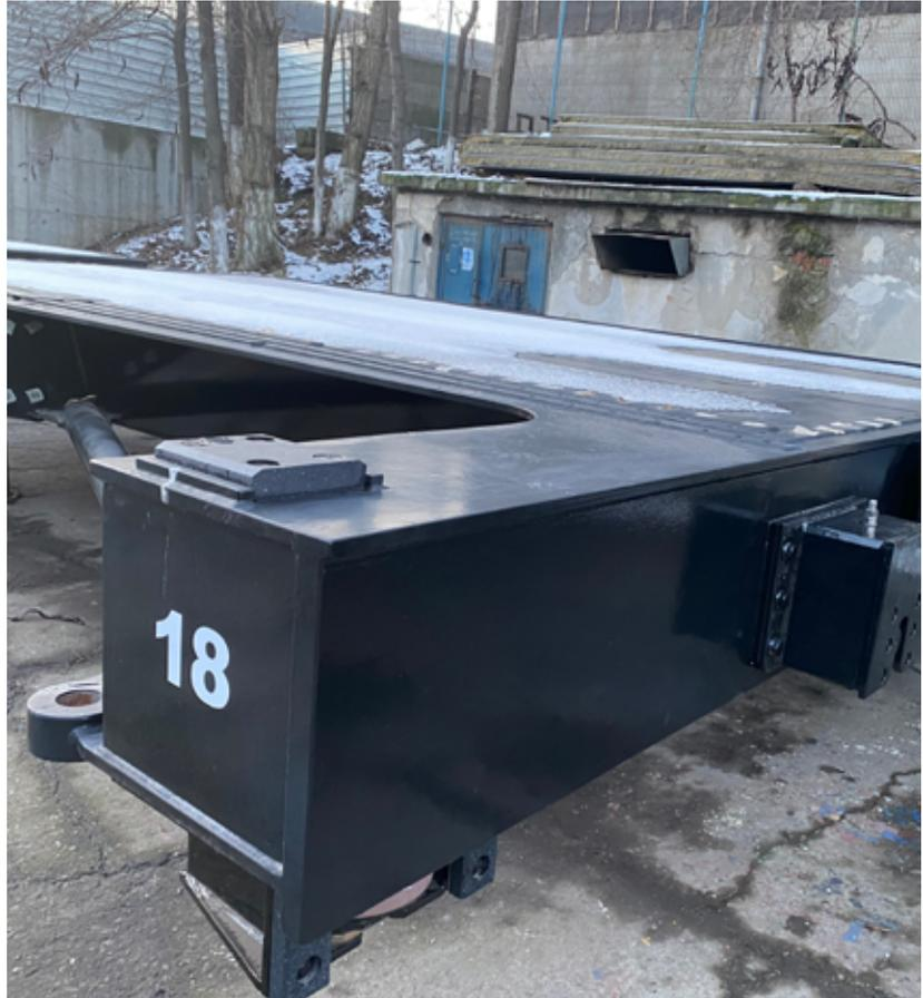
Bei eisigen Temperaturen werden die letzten Schütze für die Montage von Dichtungen und Anbauteilen vorbereitet.
