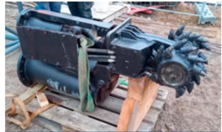
Für Härtefälle: Der modifizierte Saug-Fräskopf entfernt das verkrustete Sediment rund um die Köpfe der Auftriebspfähle.
