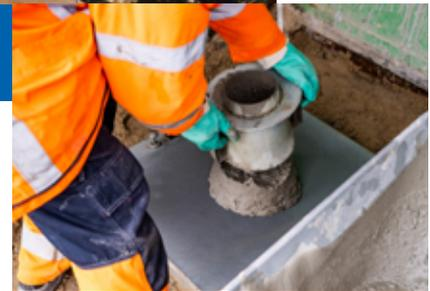
**Material-Test: Mit Normzylindern überprüfen die Betonage-teams u. a. Konsistenz und Fließverhalten des Spezialbetons.**
