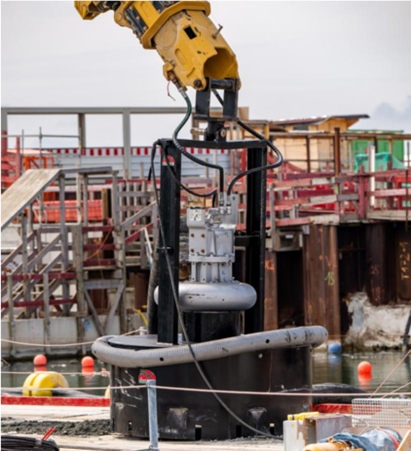
**Schweres Reinigungsgerät: Eine in der Sauglocke verbaute Jetvorrichtung entfernt anhaftendes Sediment per Wasserdruck.**
