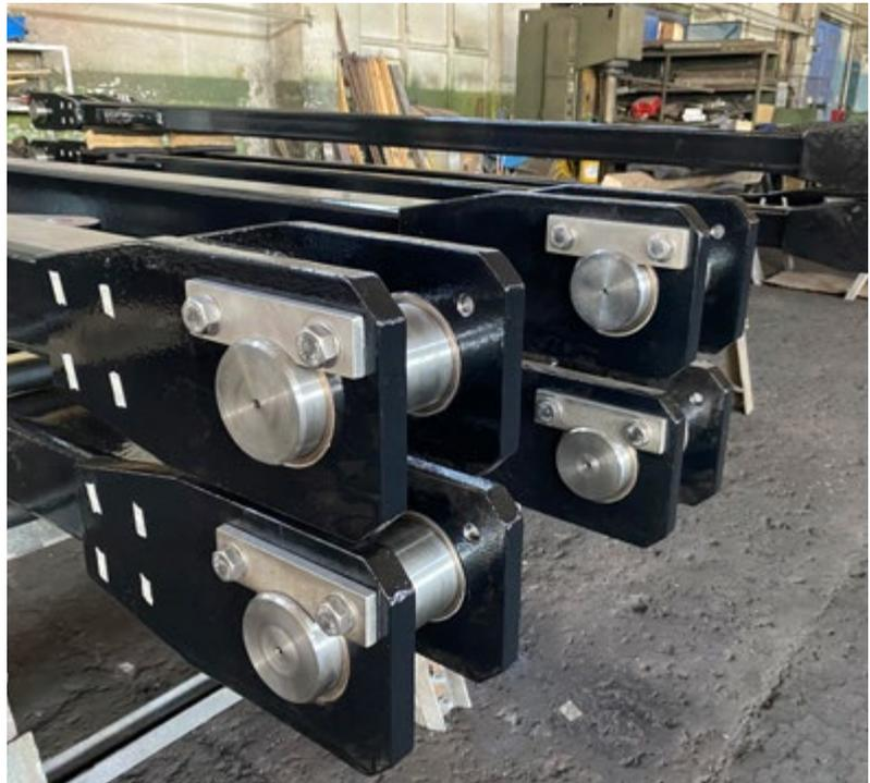
Fertiggestellte Schützgestänge in Rumänien: Sie verbinden den Hydraulikantrieb mit den einzelnen Schütztäfel, die dann individuell gesteuert werden können.
