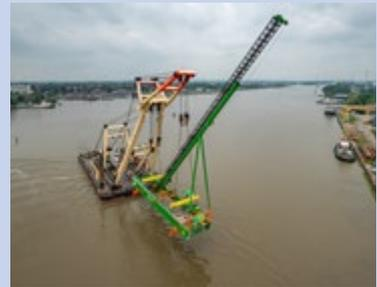
„Enak“ war bereits im Sommer 2021 auf der Baustelle für die 5. Schleusenammer im Einsatz, um zwei insgesamt 240 Tonnen schwere Arbeitsplattformen über den NOK zu transportieren und millimetergenau auf der Baugrubenumschließung des Binnenhauptes zu platzieren. Einen Bericht zu diesem Einsatz finden Sie auf unserem Blog:
