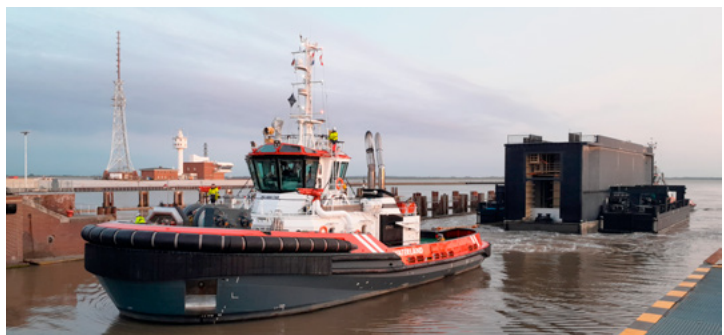
Ankunft in Brunsbüttel: Waterland schleppt Tor IX inklusive Hebepons, Waterstroom hat hinten am Schleppzug festgemacht.
