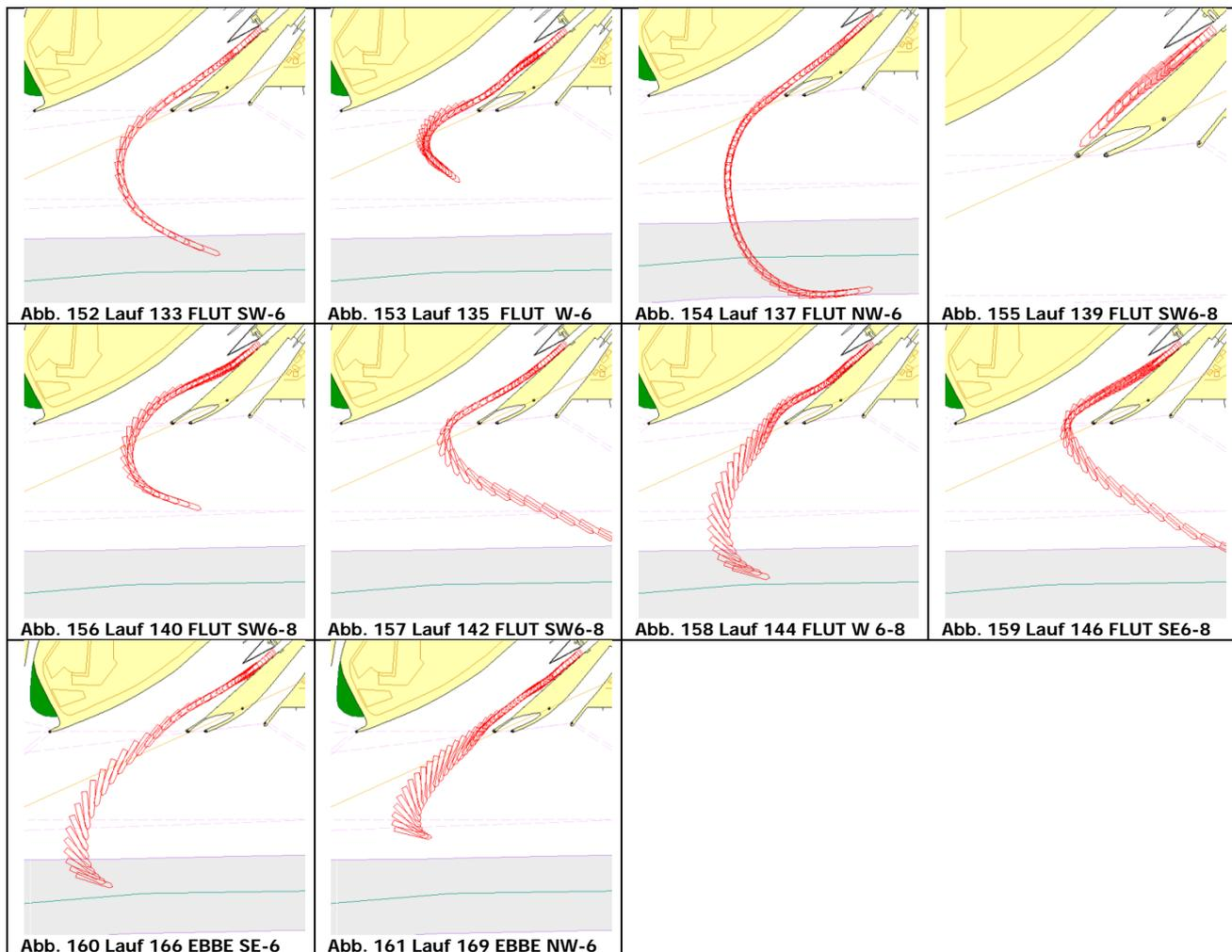
Eine erste Betrachtung der obenstehenden Laufergebnisse zeigt, dass die Bahnführungsabläufe in weiten Bereichen identisch sind, wie sie schon bei dem Containerschiff NOKmax zu beobachten waren.
