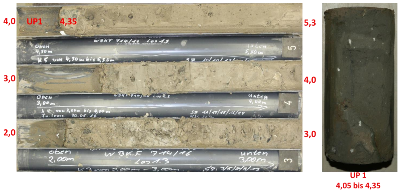
Bild 7: Kern- und Sonderproben des Geschiebemergels (WBKF_714/16)
