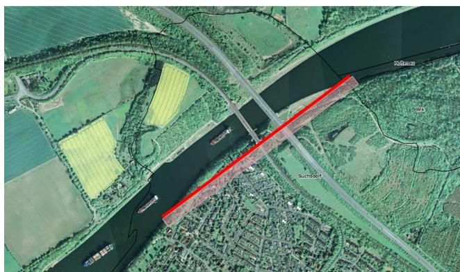
**Abbildung 6 : Kanalverbreiterung gem. Entwurf-HU. Uferlinie und Böschungseingriff rot hinterlegt.**
