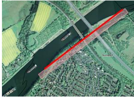
Abb. 12: Böschungseingriffe infolge Kanalverbreiterung Variante 1
