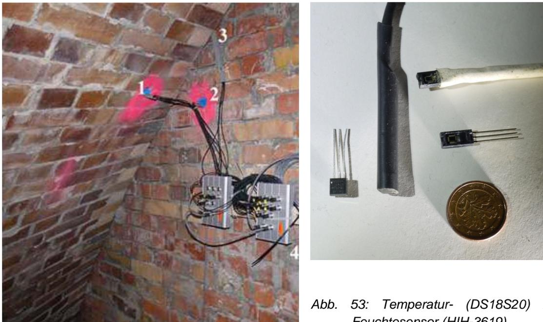
Abb. 52: Jede Messstelle umfasste drei Temperaturmesspunkte (Oberfläche, 50 cm und 100 cm in Decke und Wand so wie <wenn möglich> 100 und 200 cm in der Wandspalte) und ein Feuchtemesspunkt (50 cm bzw. 100 cm).
