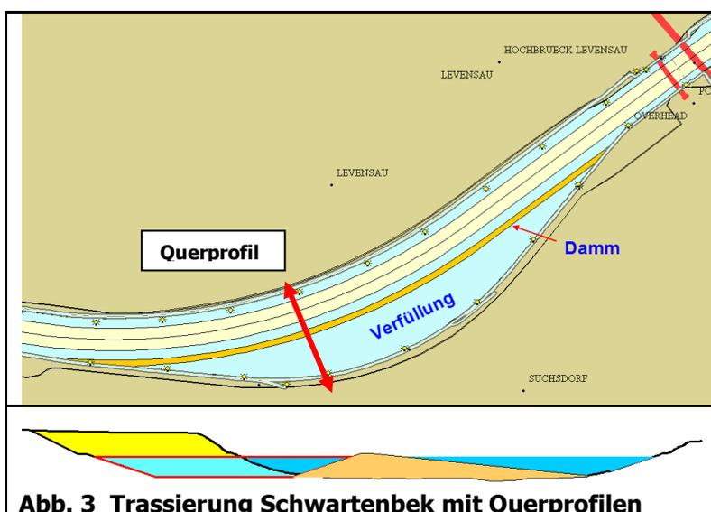
Diese Trassierungsmaßnahme (siehe Abb.3) beinhaltet neben den bereits beschriebenen Maßnahmen im Bereich der Levensauer Hochbrücken eine komplett veränderte Trassenführung des NOKs in diesem Kanalabschnitt, nicht nur durch eine verlängerte geradlinige Zuführung aus der Schwartenbek Kurve in den Brückenbereich
