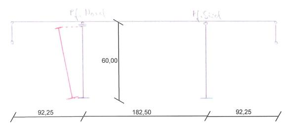
Ziel der weiteren Untersuchungen ist es daher, die Grenzen der möglichen Lagerverschiebung so zu ermitteln, dass sie für die Standsicherheit des Überbaus und des Pfeilers unbedenklich sind.
