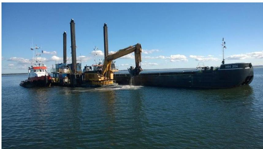
Abbildung 3: Tieflöffelschwimmbagger mit längs anliegender Schute
