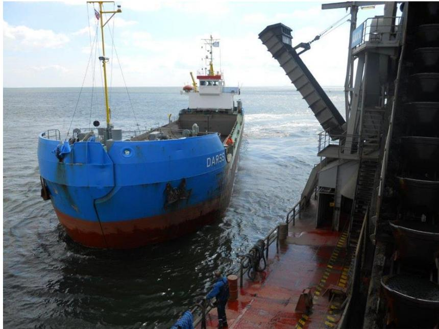
Abbildung 5: Klappschute beim Anlegen an einen Eimerkettenbagger
