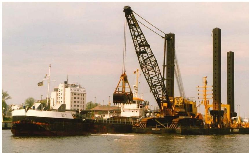
Abbildung 4: Seilgreiferbagger mit längs anliegender Schute
