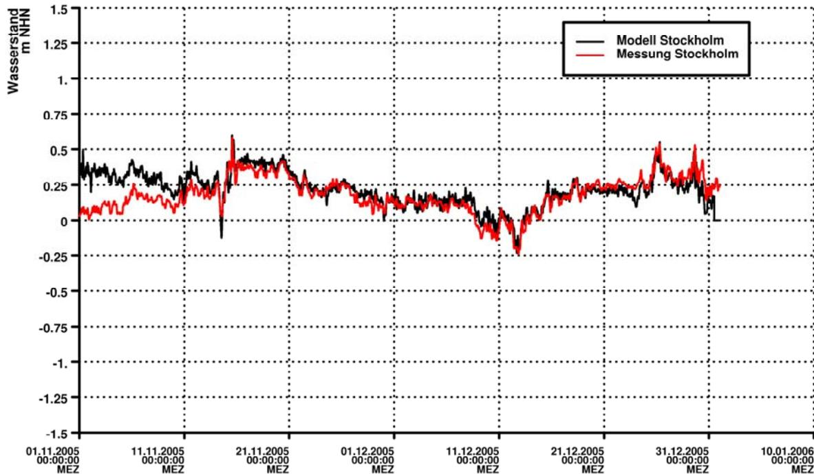
**Bild 5: Verlauf des Wasserstandes im Modell und in der Natur für den Simulationszeitraum am Pegel Stockholm.**
