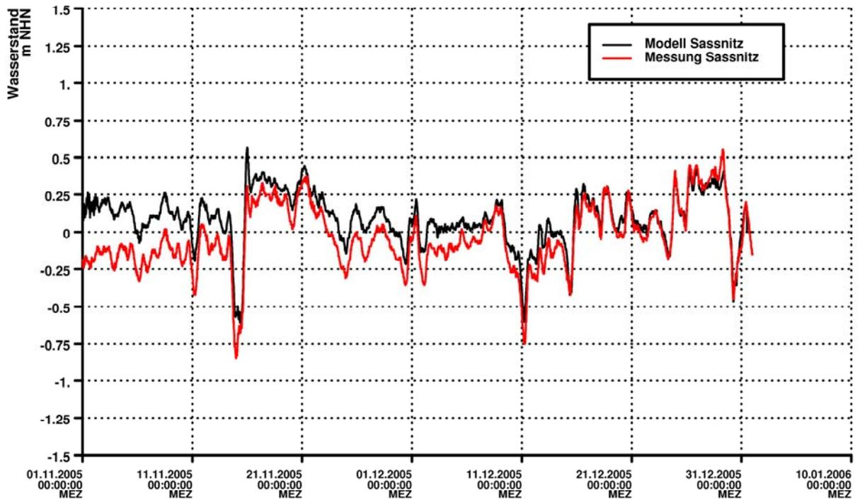
**Bild 6:** Verlauf des Wasserstandes im Modell und in der Natur für den Simulationszeitraum am Pegel Sassnitz.
