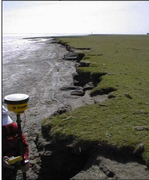
Tab. A.1.3.1-6: Terrestrische Vermessungen von Abbruchkanten zum Ist-Zustand (Nullmessung)
