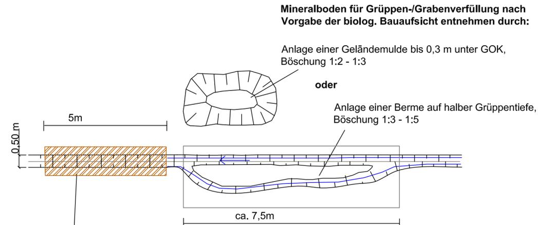
Grüppe auf 5m mit Mineralboden verfüllen, Überhöhung von 0,3 m
