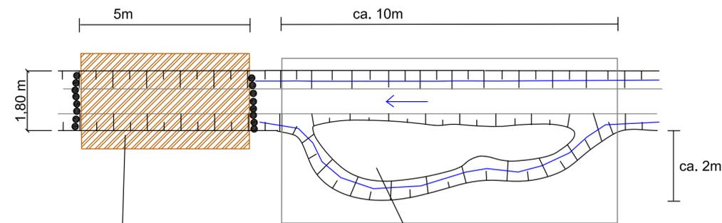
Pfahlreihen (Eiche/Birke, evtl. vor Ort entnommen) mit Abstand von 5m einbringen. Graben dazwischen mit Mineralboden verfüllen, Überhöhung von 0,3 m. Bei Bedarf nach Angabe der örtl. Bauaufsicht Unterfüllung mit Geotextilien
