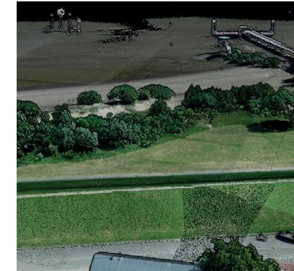
Eine bearbeitete Punktfolken-aufnahme des Ufers bei Krautschand (Niedersachsen): Das Bild bei Niedrigwasser zeigt deutlich Deich, Vorland inkl. Strand und das Watt. Die Wasserfläche im Hintergrund ist dunkel dargestellt.
