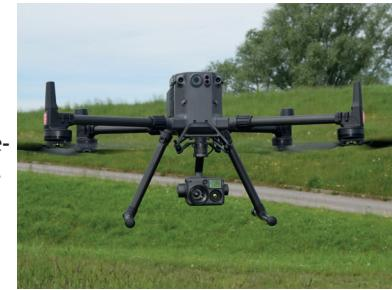
Die vom Laserscanner gesammelten Messpunkte (Punktfolken) ermöglichen u.a. sehr genaue Darstellungen von Geländeoberflächen. Für die Beweissicherung lässt sich so feststellen, ob sich z.B. Wattkanten verändert, die für die Entwicklung der Fauna (Tierwelt) bedeutend sind. Zusammen mit Daten aus der Gewässervermessung sind zudem digitale Geländemodelle möglich, anhand derer Erosions- und Sedimentationsprozesse untersucht werden können.
