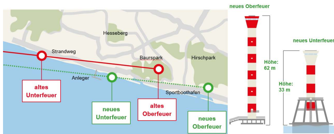
Abbildung 3-22: Systemskizze der Richtfeuerlinie Blankenese sowie Gestaltung des neuen Ober- und Unterfeuers
