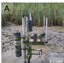
Aufbau der Messkampagne mit Druck- und Strömungsmessung (A), ergänzter Sohlhöhenmessung (B) und Aufnahme von Vegetationsdaten (C)
