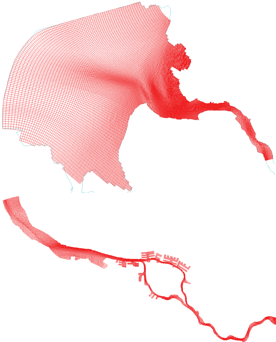
Bild 2 - 1: Gitternetz des Delft3D Modells, das für die parallele Berechnung in zwei Gebiete aufgeteilt wurde (domain decomposition).
