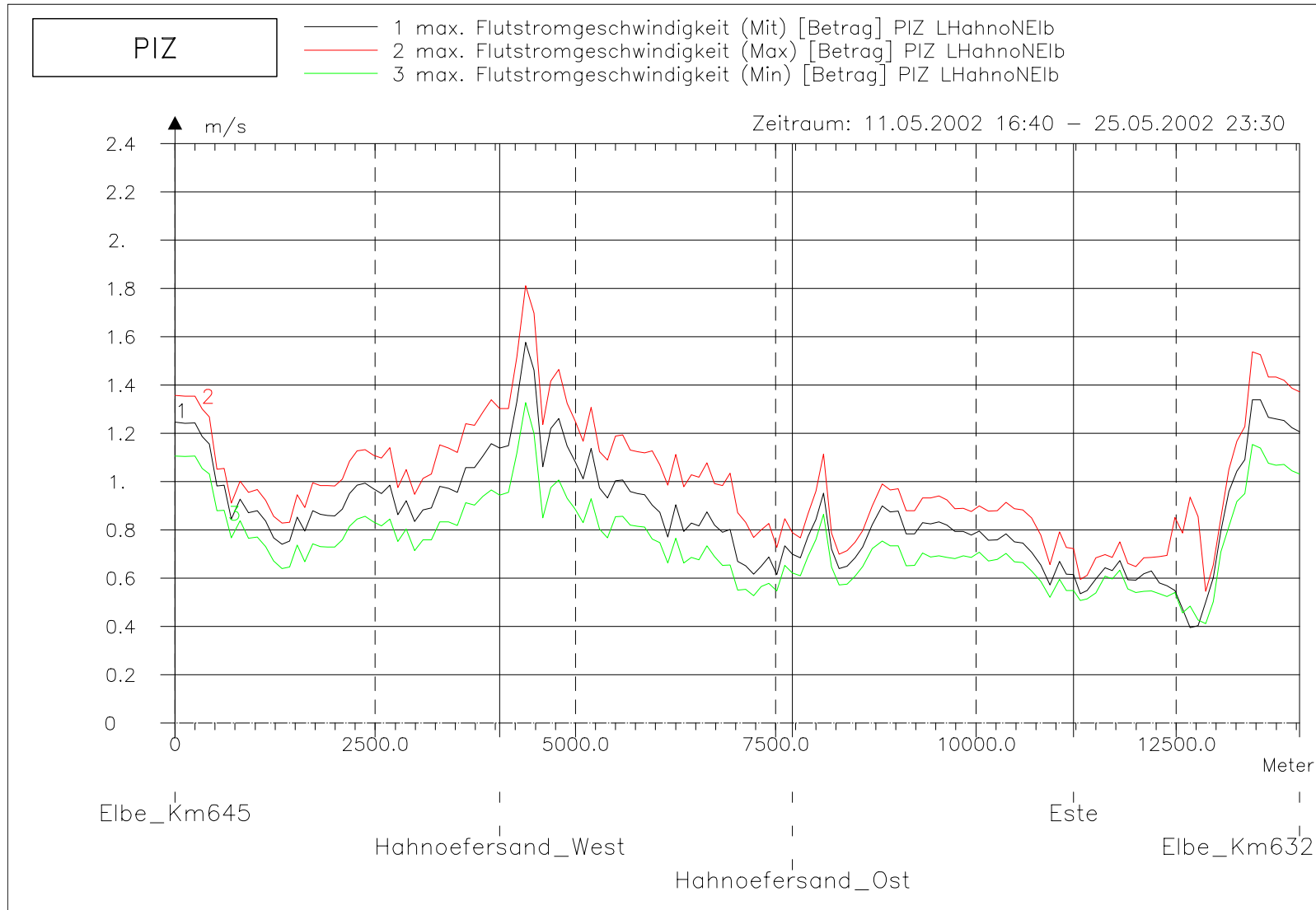
Bild 125: maximale Flutstromgeschwindigkeit bei hohem Oberwasser entlang der tiefsten Rinne der Hahnöfer Nebenelbe
