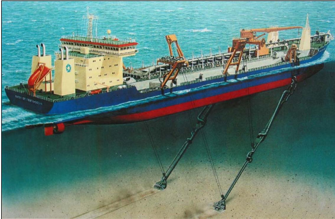
**Abbildung 2.5-1: Darstellung der Arbeitsweise eines Hopperbaggers**
