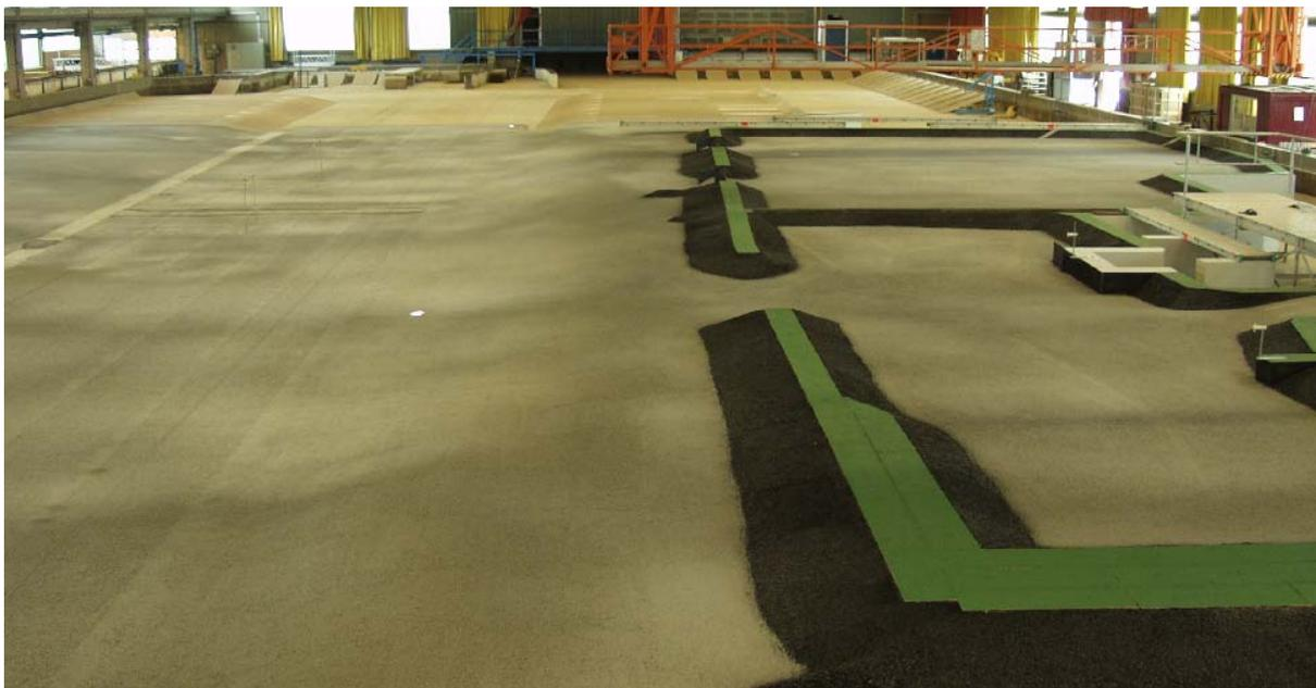
Bild 13: Modellabschnitt Unterelbe mit Fahrrinne (links), Hamburger Yachthafen (Hintergrund, rechts) und Außenbezirk Wedel des WSA Hamburg (vorn rechts) im Maßstab 1 : 40
