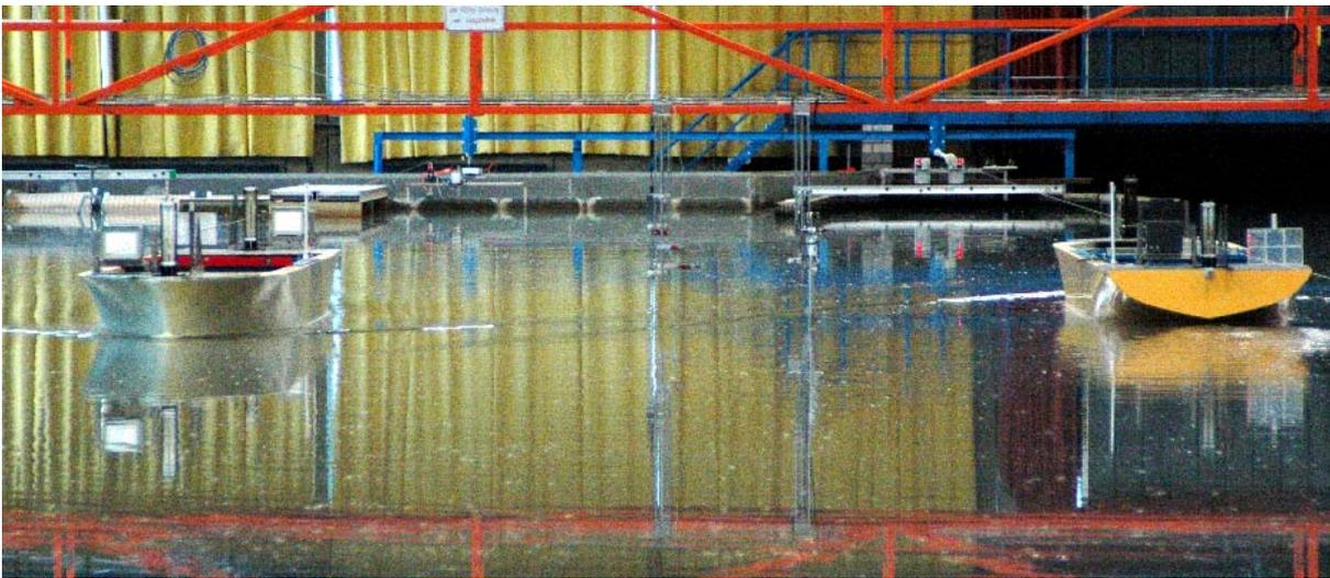
Bild 16: Zwei Containerschiffe PPM46 bei der Begegnung im hydraulischen Modell (385m-Trasse;  $T_{nw}$ ;  $t = 13,8$  m;  $v_S \approx 10$  kn)
