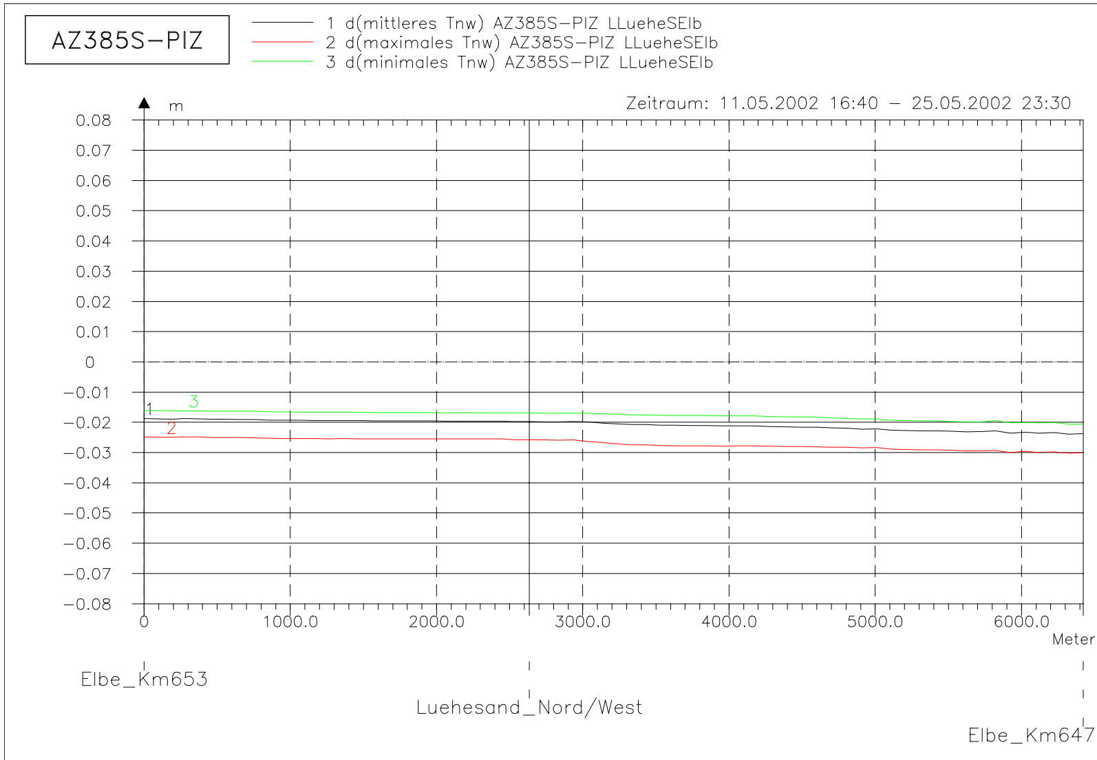
Bild 28: Differenz des Tideniedrigwassers (AZ385S-PIZ) bei niedrigem Oberwasser entlang der tiefsten Rinne der Lühesander Süderelbe
