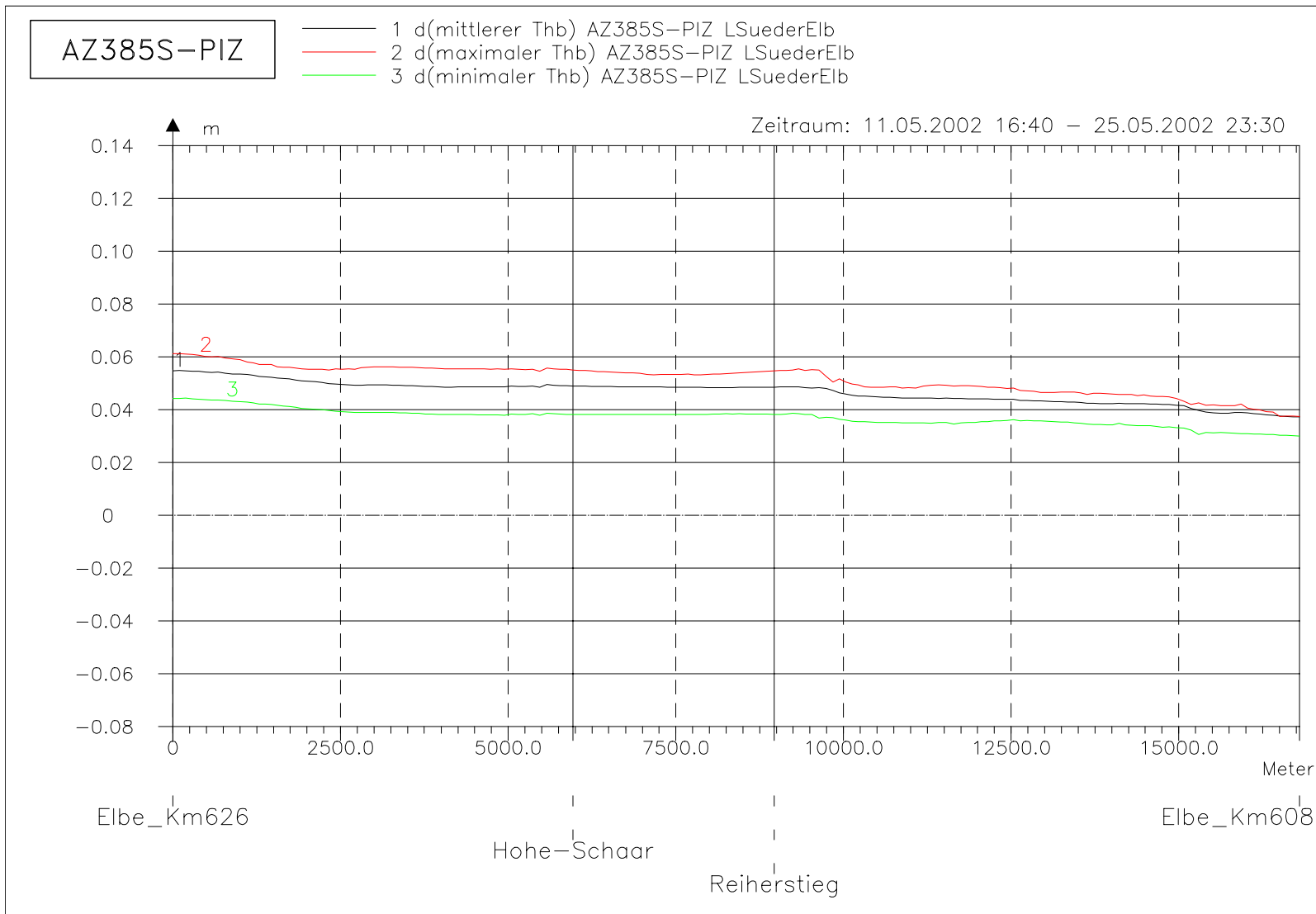
Bild 48: Differenz des Tidehubes (AZ385S-PIZ) bei niedrigem Oberwasser entlang der tiefsten Rinne der Süderelbe
