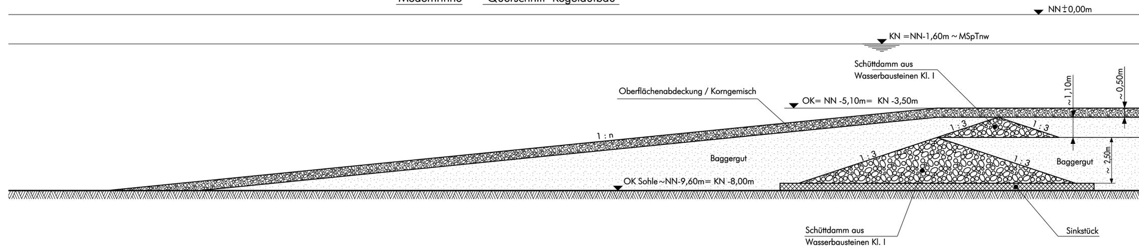
Neufelder Sand -Querschnitt Regelaufbau-
