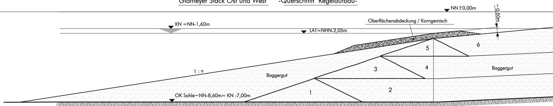
St. Margarethen, Scheelenkuhlen, Brokdorf -Querschnitt Regelaufbau-
