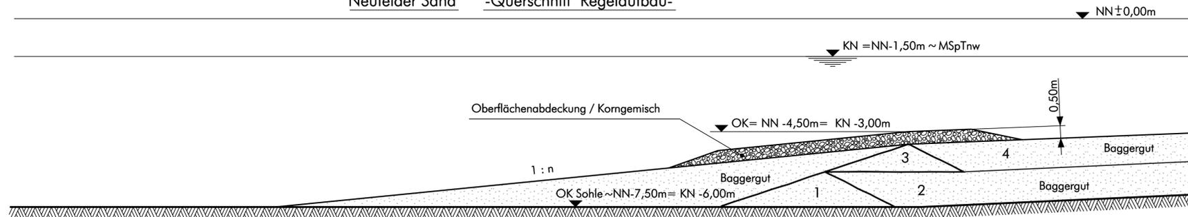
Glameyer Stack Ost und West -Querschnitt Regelaufbau-
