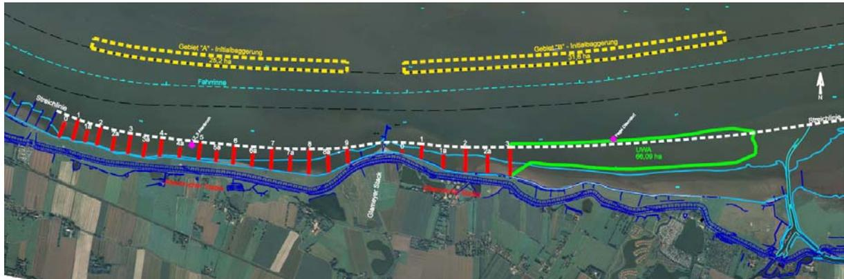
**Abbildung 2: Lage der Buhnen, Unterwasserablagerungsfläche und Initialbaggerung (Planänderungsunterlage II Teil 1, Abb. 4.3-1)**
