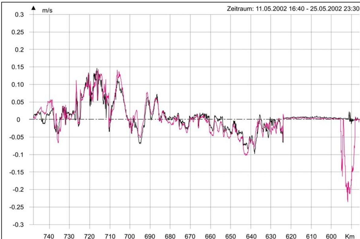
**Abbildung 11: Ausbaubedingte Änderung der mittleren Ebbestromgeschwindigkeit in Schwarz für (AZ385S – PIZ) und in Magenta für (AZ\_09 – PIZ\_02)**
