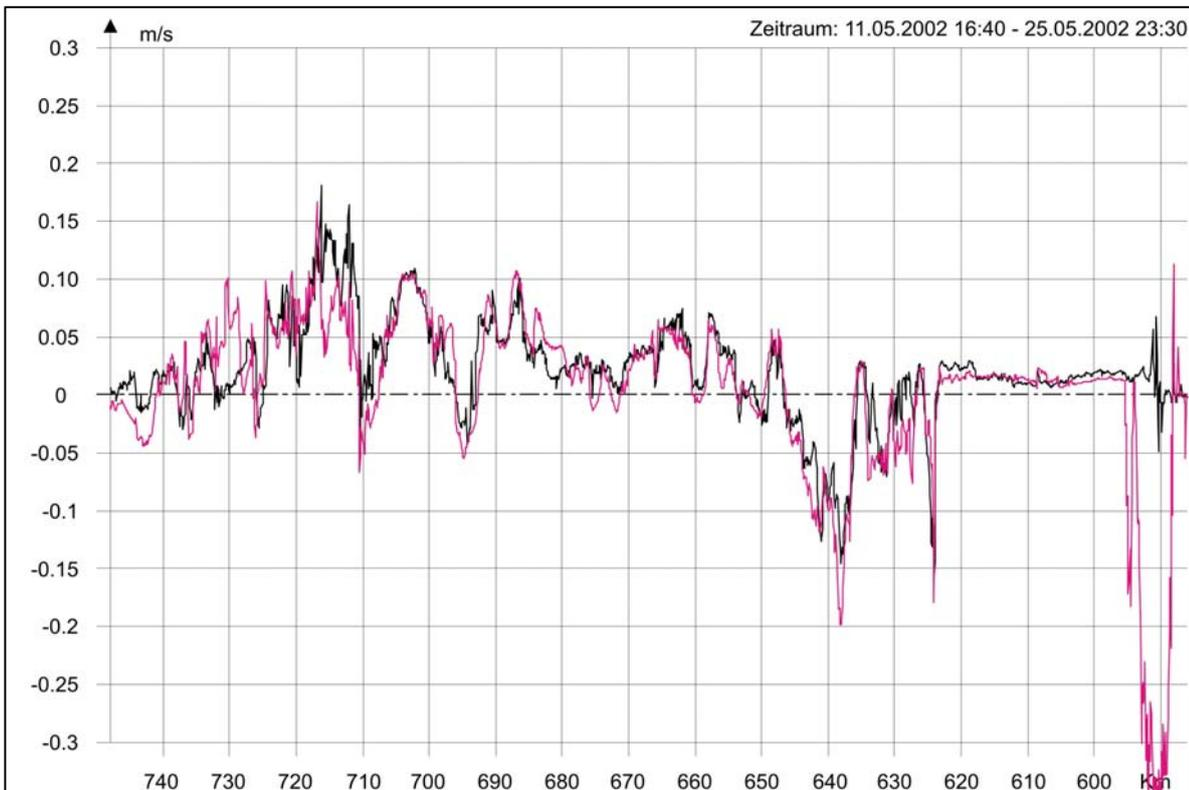
**Abbildung 13: Ausbaubedingte Änderung der maximalen Flutstromgeschwindigkeit in Schwarz für (AZ385S – PIZ) und in Magenta für (AZ\_09 – PIZ\_02)**
