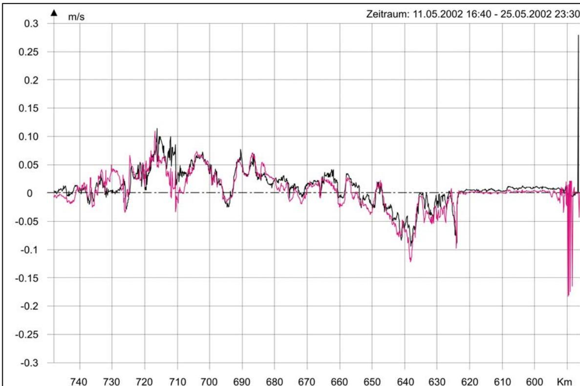
**Abbildung 9: Ausbaubedingte Änderung der mittleren Flutstromgeschwindigkeit in Schwarz für (AZ385S – PIZ) und in Magenta für (AZ\_09 – PIZ\_02)**
