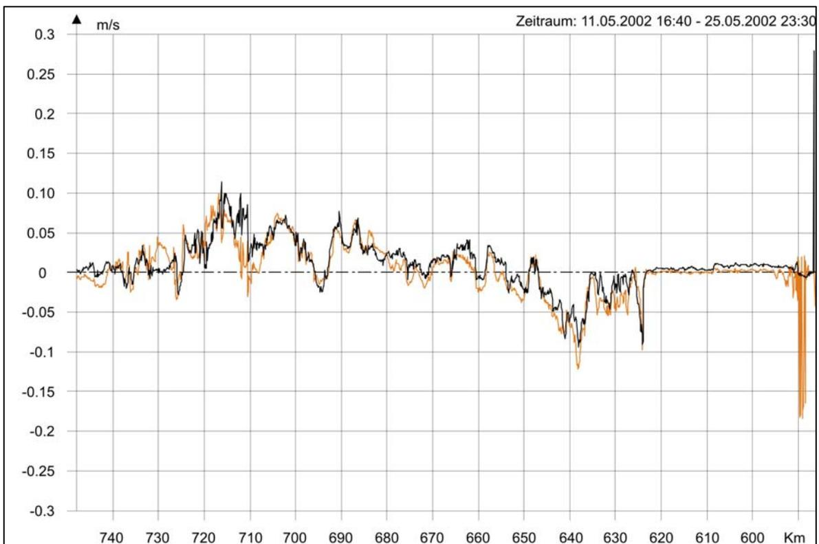
**Abbildung 10: Ausbaubedingte Änderung der mittleren Flutstromgeschwindigkeit in Schwarz für (AZ385S – PIZ) und in Rotbraun für (AZ\_10 – PIZ\_02)**
