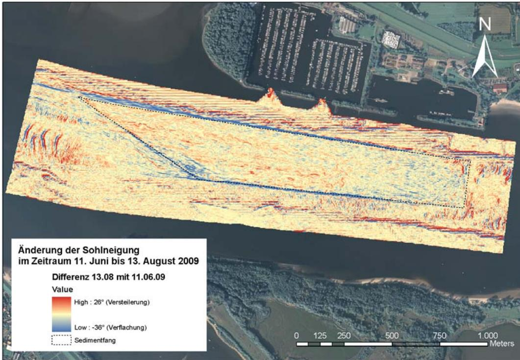
**Abbildung 3-16: Bilanzierung der Veränderung der Böschungsneigung für den Zeitraum 11. Juni 2009 bis 13. August 2009 auf Grundlage der flächenhaften Peilungen an diesen Daten.**
