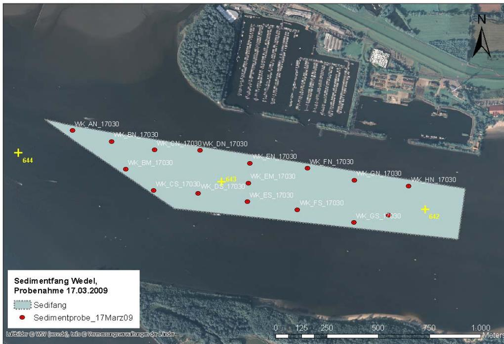
Abbildung 2-4: Übersicht Probenahmepunkte bei Sedimentbeprobung am 17.03.2009
